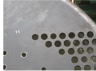
図13 管穴の実例(株ヒラカワ製造部による)
