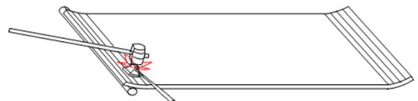
図9 ハンマーによる端曲げ加工
