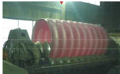
図23 熱間ローラによる波型炉筒製作
