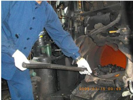
図6 蒸気機関車の投炭状況
