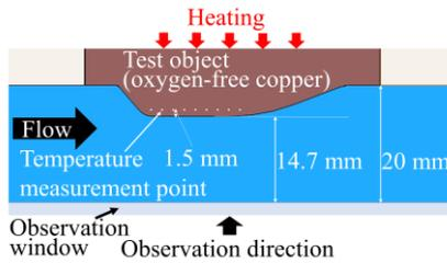
図 12 加熱ノズルの形状[16]
